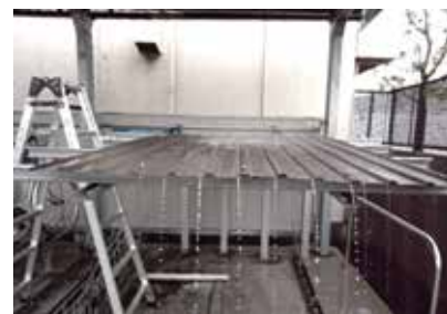
■散水状況(ガルバリウム鋼板)
